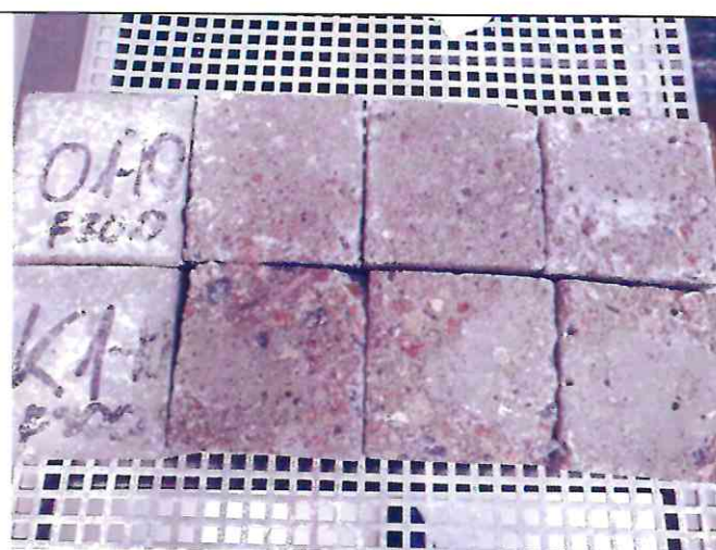
30 pav. Bandiniai (kontroliniai su CEM I 42,5 R (K1) ir tiriamieji (O1) su CEM II/ A-P 52,5 N po atsparumo šalčiui F300 atitirpinant 3 % NaCl vandeniniame druskos tirpale.
