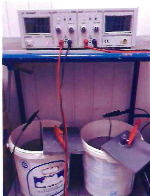
37 pav. Bandinių sujungimas su prietaisu ir bandymo eiga
