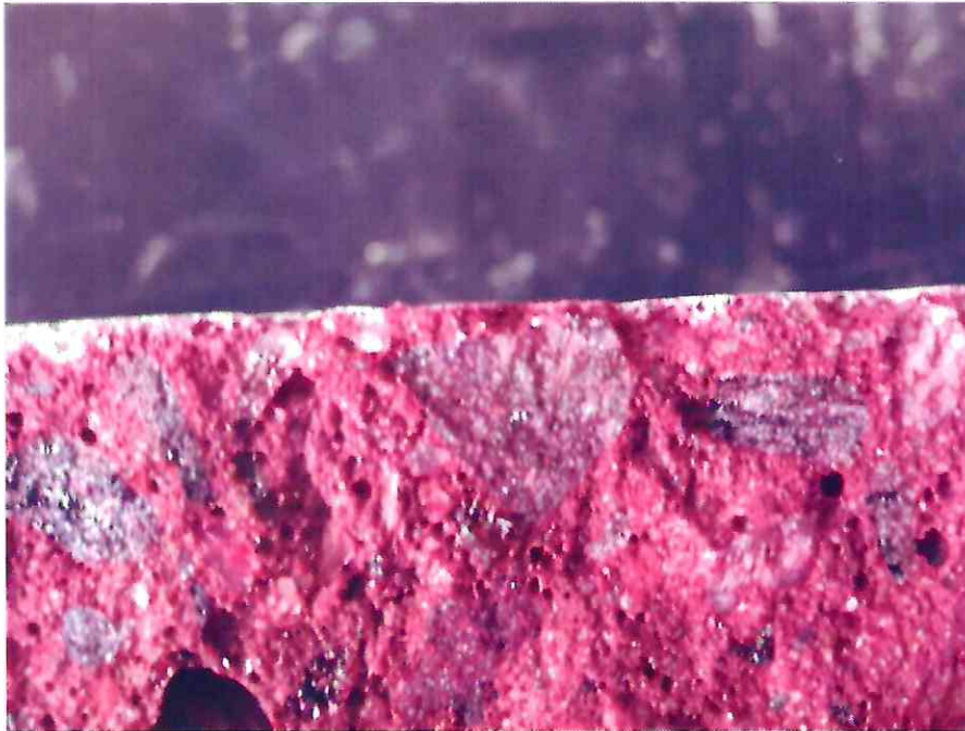
44 pav. Betono bandinių su CEM II/ B-M (P-LL) 42.5 N portlandcemenčiu, karbonizacijos gylis po 6 mėnesių kietėjimo natūraliose sąlygose ore buvo mažesnis, nei 0,5 mm
