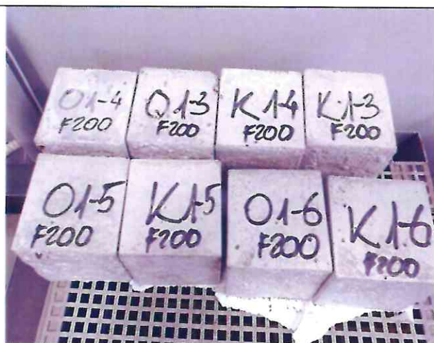
29 pav. Bandiniai prieš atsparumo šalčiui bandymą (kontroliniai (K1) su CEM I 42,5 R ir tiriamieji (O1) su CEM II/ A-P 52,5 N (bandoma F200 ir F300))
