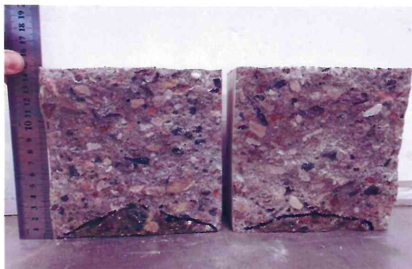
34 pav. Vandens įsiskverbimo gylis bandinius veikiant 1,2 MPa slėgiu. Kairėje pusėje kontrolinės sudėties bandinys, dešinėje opoka modifikuoto (CEM II/ A-P 52.5 N) cemento betono bandinys.
