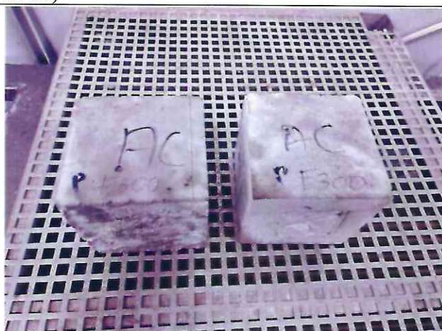
31 pav. Bandiniai prieš atsparumo šalčiui bandymą tiriamieji (AC) su (CEM II/ B-M (P-LL) 42.5 N) (bandoma F200 ir F300)
