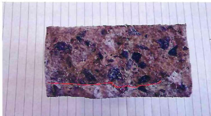
**39 pav.** Opoka modifikuoto cemento CEM II/ B-M (P-LL) 42,5 N betonas ir jame matomas chloridų įsiskverbimo gylis, kurio vidutinė vertė yra 9,5 mm
