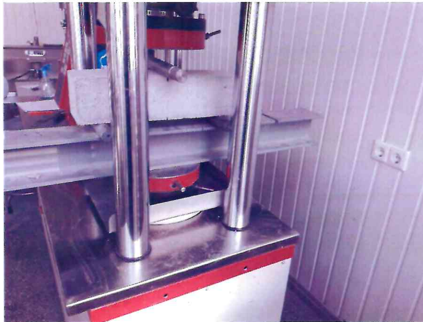
40 pav. Betono lenkimo bandymas pagal trijų taškų schemą
