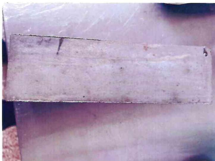
25 pav. Bandinys O3 po 10 sav. laikymo izoterminėje kameroje
