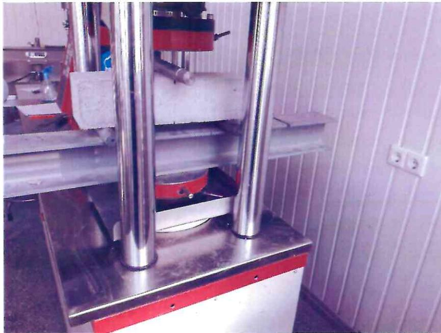
40 pav. Betono lenkimo bandymas pagal trijų taškų schemą
