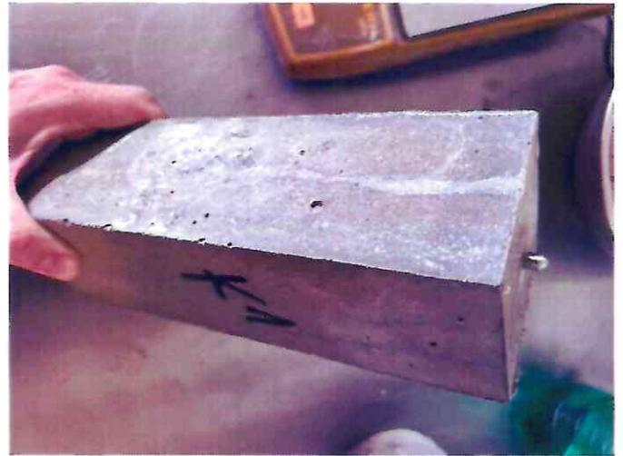
15 pav. Bandiniai po 10 sav. laikymo izoterminėje kameroje
