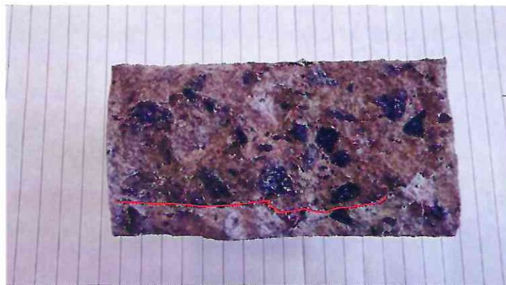
39 pav. Opoka modifikuoto cemento CEM II/ B-M (P-LL) 42,5 N betonas ir jame matomas chloridų įsiskverbimo gylis, kurio vidutinė vertė yra 9,5 mm
