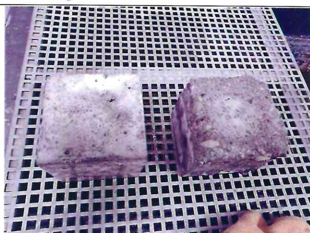
32 pav. Bandiniai po atsparumo šalčiui F300 atitirpinant 3 % NaCl vandeniniame druskos tirpale naudojant (CEM II/ B-M (P-LL) 42.5 N)
